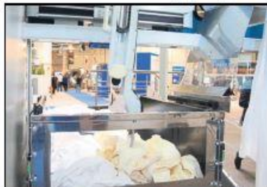
Eine 3D-Kamera verfolgt dem Roboterarm »Sahkrafs«, so dass er Wäscheteile einzeln greift und weiteren Arbeitsschritten zuführt.
