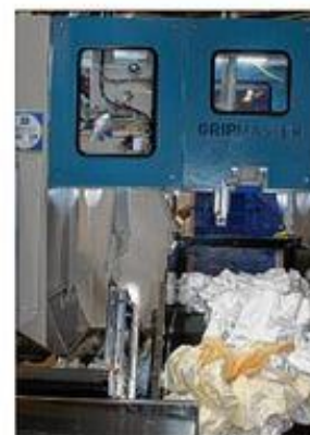
Der Wäscherei-Roboter „Gripmaster“ sortiert selbstständig Textilien.
